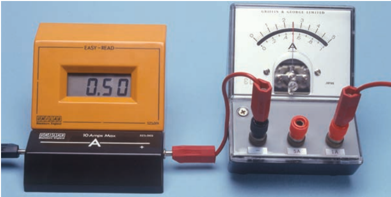
■ Figura 1.2 Amperímetro analógico y amperímetro digital utilizados para medir la misma intensidad de corriente eléctrica
